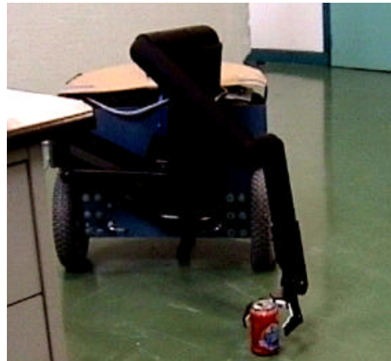
Fig.1. Représentation du porteur équipé du bras Manus, lors d'une tâche de saisi au sol.
